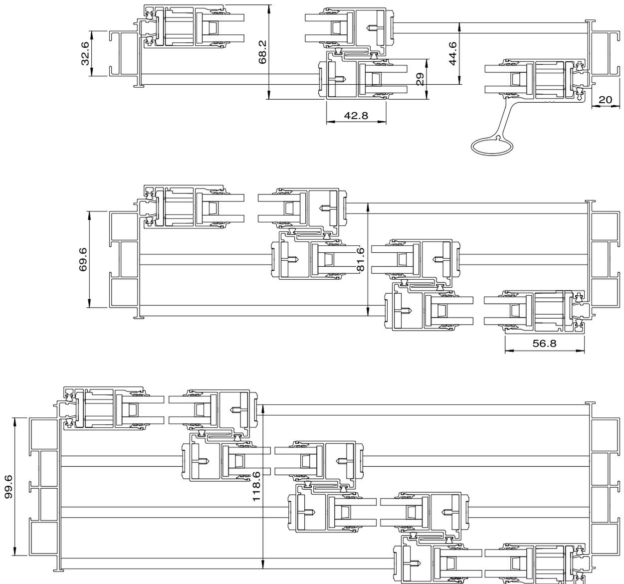
**Horizontalschnitte Schiebeanlage 150**
