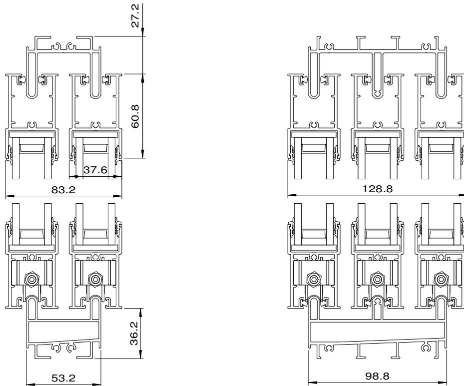
**Vertikalschnitte Schiebeanlage 155**
