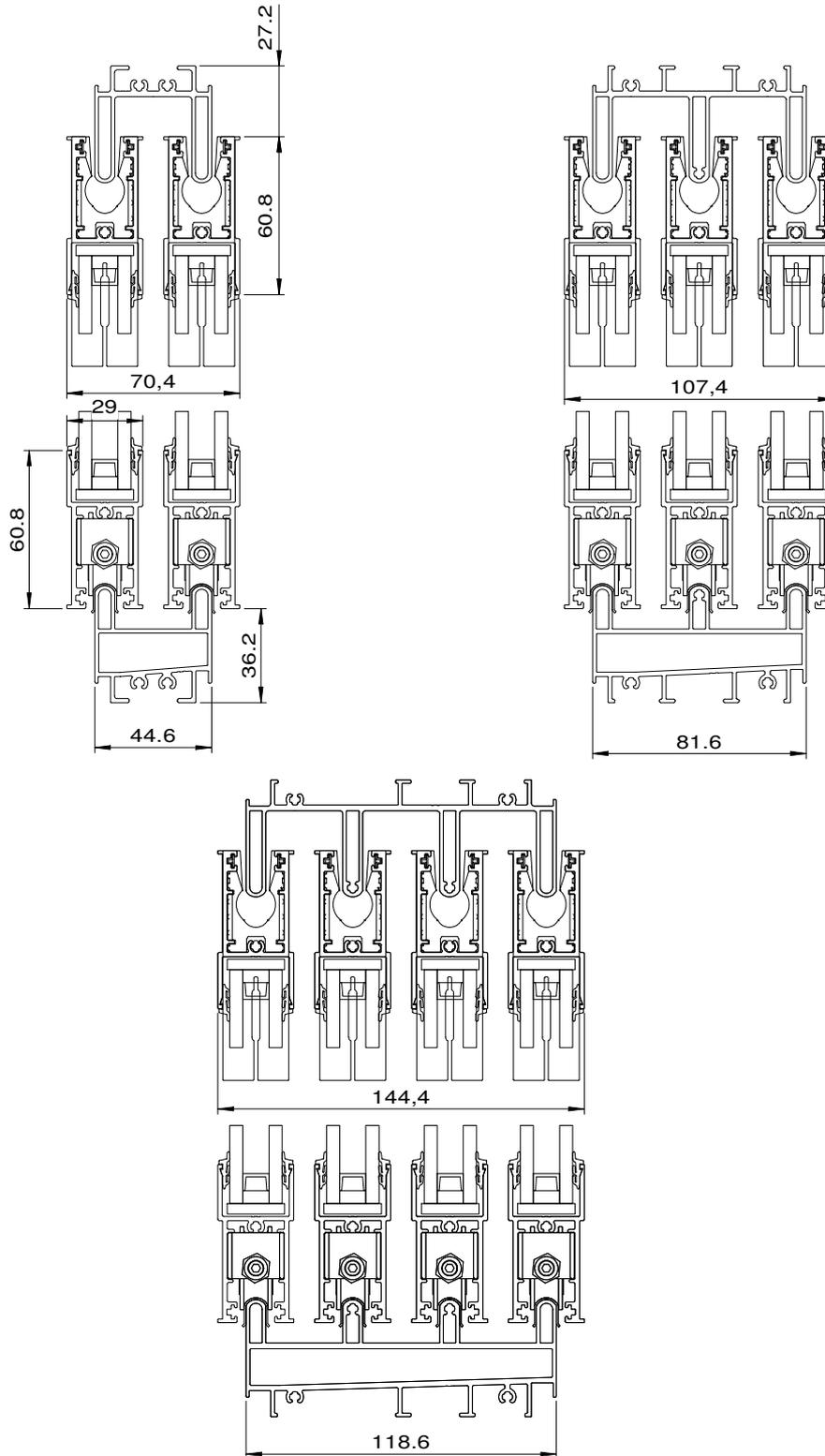
**Vertikalschnitte Schiebeanlage 150**
