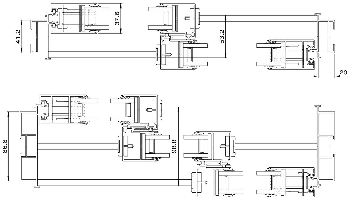
**Horizontalschnitte Schiebeanlage 155**
