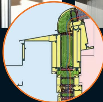
Einzigartig – die hochwärmegedämmten Profile mit zertifiziertem  $U_f$ -Wert nach Passivhausstandard und integrierter Traufe, Beschattungs- und Beleuchtungssystemen.
