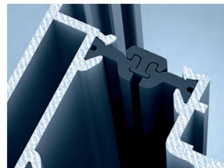
**Schritt 3:** Die Einschubfedern werden wieder eingesetzt. Der Profilverbund bleibt teilweise intakt und auftretende Schubkräfte können sich nicht auf das HS-Getriebe und den Schließzylinder übertragen. Im Bereich des getrennten Verbunds verhält sich das Profil durch die Einschubfeder bei Querszugkräften, die zum Beispiel bei einem Einbruchversuch auftreten, wie ein Profil mit konventionellem Verbund.
