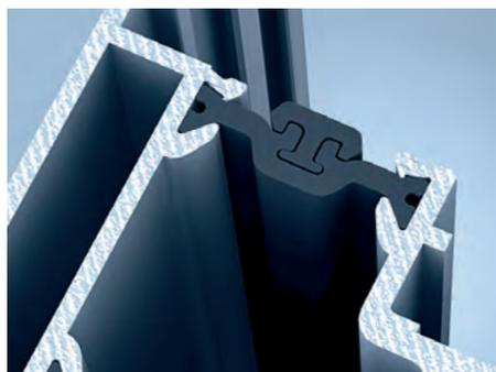
**Schritt 1:** Um den massiven Einfluss der Temperaturunterschiede auf die Funktion und die Optik der Hebe-Schiebeelemente zu vermeiden, gibt es den patentierten verzugs-hemmenden heroal Profilverbund. Er schützt das Profil vor den schädlichen Schubkräften. Dieser Verbund besteht aus einem fest eingerollten Isoliersteg und einer Einschubfeder.
