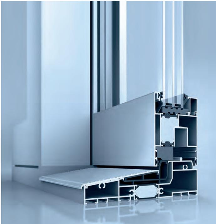
Die Energieeffizienz zählt: Das Profilsystem S 77 HI bietet als konsequente Weiterentwicklung des Hebe-Schiebesystems heroal S 77 eine modular aufgebaute Dämmzone und Dichtungstechnik in drei Ebenen zur Flügel- und Mittelstoßabdichtung. Damit können  $U_w$ -Werte von  $\geq 1,0 \text{ W/m}^2\text{K}$  realisiert werden. Hochwertige und wirtschaftliche Dämmstoffe kommen in den wärmetechnisch kritischen Konstruktionsdetails der Hebe-Schiebetür zum Einsatz.
