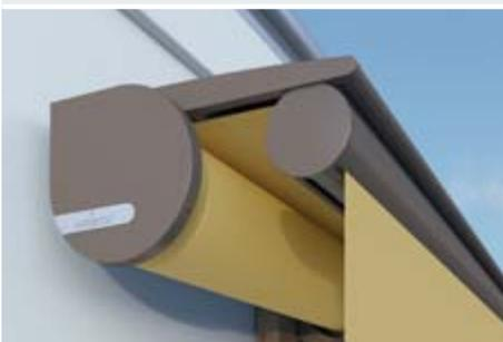
Wandmontage auf Beton C20/25 mit einer Vorsatzverschalung bis zu 200 mm, Windwiderstandsklasse 2 und einer zulässigen zentrischen Zuglast für Bolzenanker von 5,71 kN
