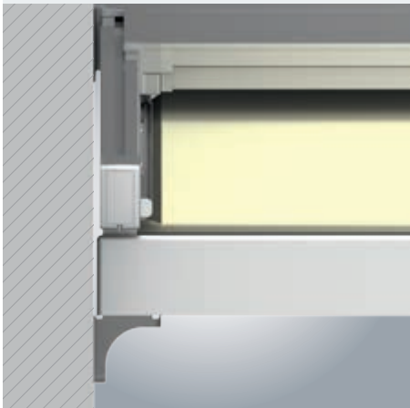
Befestigung der Dachrinne seitlich an einer Wand mit dem Befestigungswinkel Dachrinne
