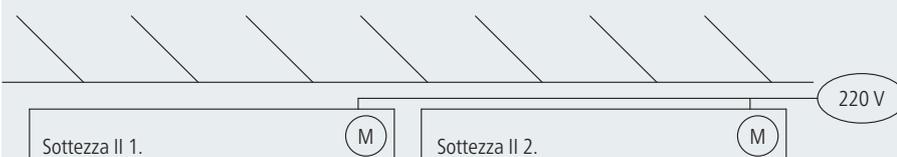
Kabel der Sottezza II 1. wird auf der Rückseite der Sottezza II 2. verlegt, da rechts der Stromanschluss ist.
